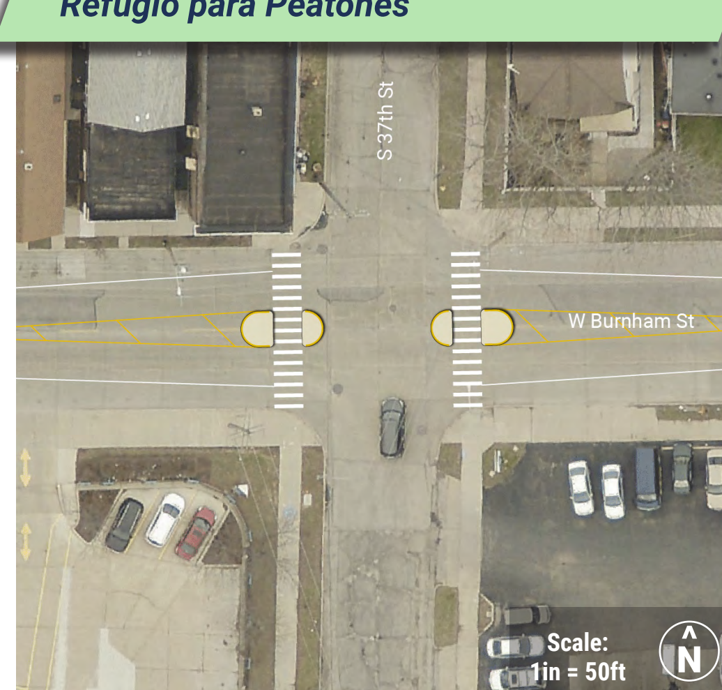
8: Pedestrian refuge islands/Isas de Refugio para Peatones
